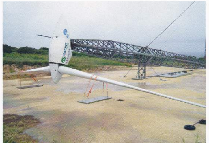
台風時の養生の状況
