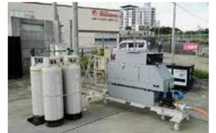
中圧供給用加圧式移動式ガス発生装置
