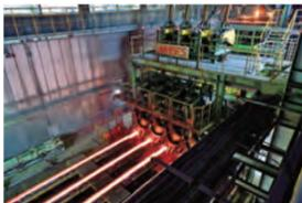
製鋼工程・圧延工程を経て鉄筋に成形される
