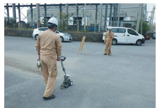
▲埋設ガス導管漏洩検査(中城村内)
