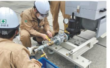
▲移動式ガス発生装置組立作業の様子
